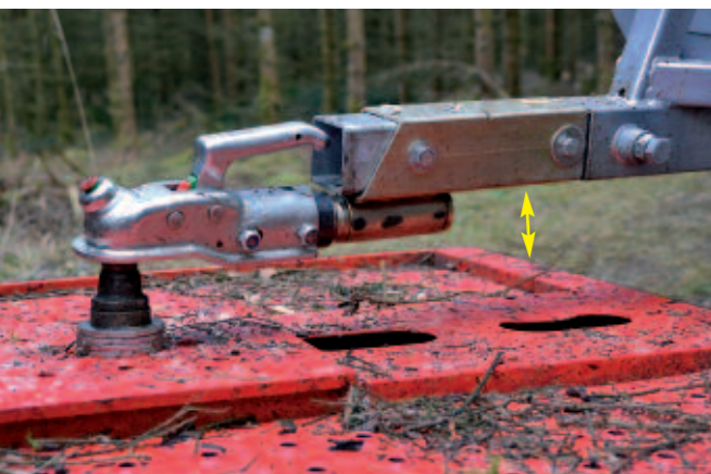
Oben: Voll ausgezogen bietet der Anhänger 270 Zentimeter Ladefläche, auch Rungebänke und Stürringter können verschoben werden. Unten: Die Kugelpfanne montierte Bernd Geyer unterhalb der Deichsel, während sie serienmäßig darüber sitzt. So gewinnt er einigen Platz zwischen Deichsel und Eisernem Pferd, die Gefahr einer Beschädigung wird deutlich minimiert.
