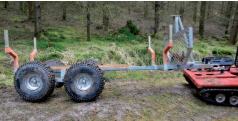
Oben: Voll ausgezogen bietet der Anhänger 270 Zentimeter Ladefläche, auch Rungebänke und Stürringter können verschoben werden. Unten: Die Kugelpfanne montierte Bernd Geyer unterhalb der Deichsel, während sie serienmäßig darüber sitzt. So gewinnt er einigen Platz zwischen Deichsel und Eisernem Pferd, die Gefahr einer Beschädigung wird deutlich minimiert.
