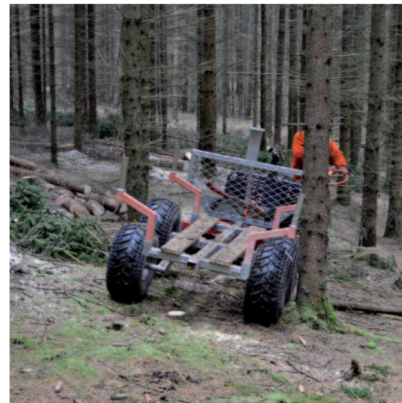
Mit etwas Übung läßt sich das Gespann prima mitten durch den Bestand zirkeln – allerdings ausschließlich vorwärts, beim Rückwärtsfahren neigt der Anhänger zum Eindrehen.
