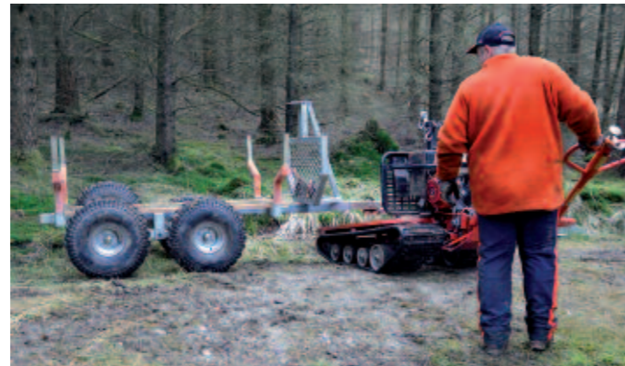
Oben: In der kürzesten Position beträgt die Gesamtlänge des Anhängers lediglich 240 Zentimeter. Unten: Alles per Hand: Nicht nur im Bestand muß jedes Stück Holz angefaßt werden, auch beim Verladen auf Pick-up und Anhänger kommen die Geyer-Jungs ins Schwitzen.
