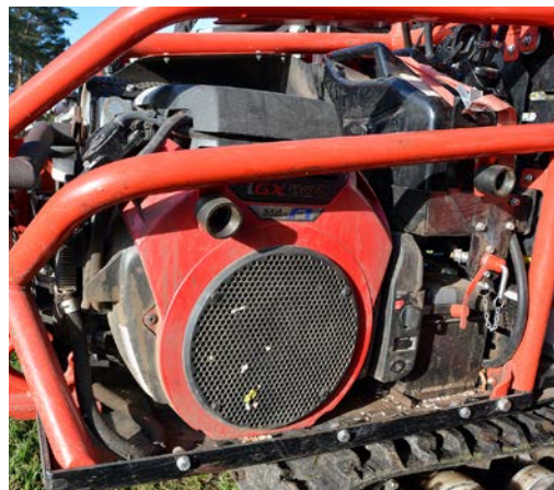
Schnell erreichbar: aufklapp- und abnehmbare Motorabdeckungen zur Wartung. Interessantes Detail: Der Kraftstofftank besteht aus einem herausnehmbaren 10-Liter-Kanister zur flexiblen Betankung (oben rechts).
